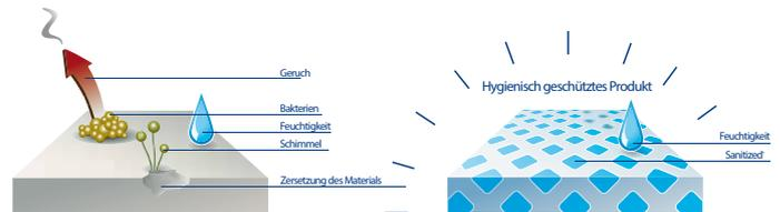
Die in Glaspartikeln eingekapselten Silberionen werden bei Kontakt mit Feuchtigkeit aktiviert. Sie neutralisieren die Bakterien, verhindern die Zellteilung und reduzieren so das Kontaminationsrisiko. Die auf Ag+-ionen basierende Sanitized®-Behandlung migriert nicht mit den Substanzen, mit denen sie in Kontakt kommt, und sie nimmt auch nicht mit der Zeit ab. Im Gegensatz zu synthetischen und organischen antimikrobiellen Mitteln.
